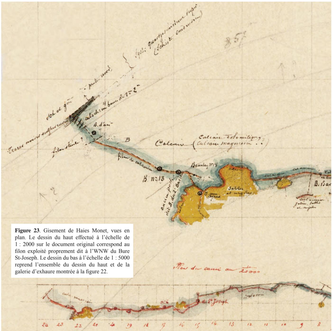
**Figure 23.** Gisement de Haies Monet, vues en plan. Le dessin du haut effectué à l'échelle de 1 : 2000 sur le document original correspond au filon exploité proprement dit à l'WNW du Bure St-Joseph. Le dessin du bas à l'échelle de 1 : 5000 reprend l'ensemble du dessin du haut et de la galerie d'exhaure montrée à la figure 22.
