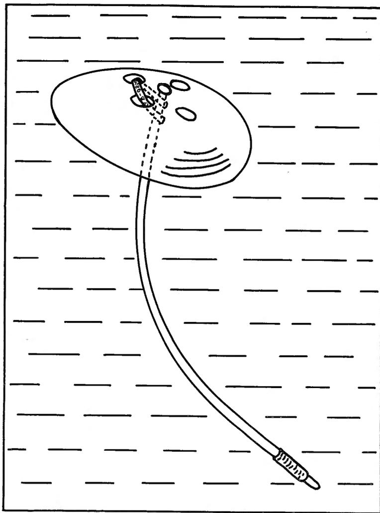
Fig. 3. — Flotteur de fond « Woodhead Sea-Bed Drifter ».
