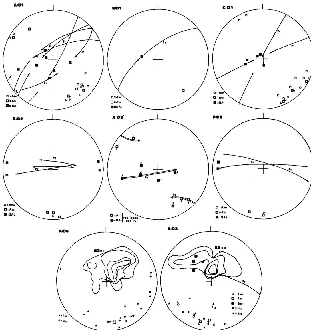
Fig. 3 - Le stéréogramme A:D2 exprime le plissement par  $P_2$  de la surface axiale  $SA_1$  et de la charnière  $A_1$  du pli  $P_1$ , les mesures provenant des 5 tronçons homogènes numérotés de 1 à 5 dans le secteur A de l'affleurement. Les pôles des surfaces axiales  $SA_1$  se répartissent sur un grand arc de cercle tandis que les axes  $A_1$  se répartissent sur un petit arc de cercle.
