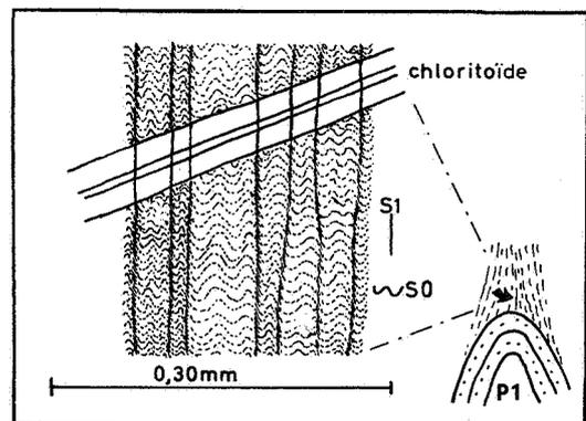
Fig. 11 - Micropli  $P_1$  dans le Revinien avec clivage de crénulation  $S_1$  plan-axial et un porphyroblaste de chloritoïde post-kinématique vis-à-vis de  $D_1$ .
