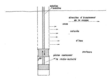
Fig. 2. — Appareillage d'injection de traceurs radio-actifs.
