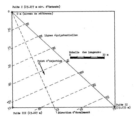
Fig. 11. — Détermination du gradient hydraulique à l'aide de trois piézomètres.
