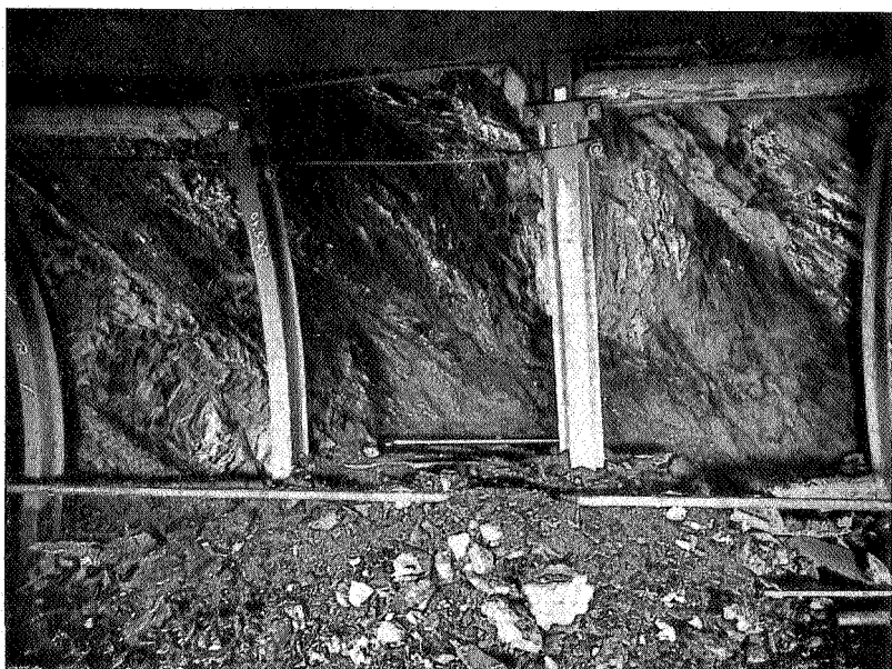
FIG. 4. — Dérangement de 563 m (photo de 561 à 564,50 m); dans le coin inférieur gauche, la couche « Anglaise » surmontée régulièrement par une faible épaisseur de son toit; dans le coin supérieur droit, la couche « Ahurie », surmontée régulièrement par son toit et reposant sur une faible épaisseur de son mur; entre les deux cadres du centre sur-épaisseur de charbon injecté tectoniquement.
