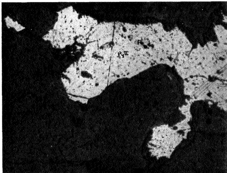
PHOTO n° 2. — Pyrite<sup>II</sup> (deuxième génération) avec une inclusion de pyrrhotine (P), sulfure de la première génération.
