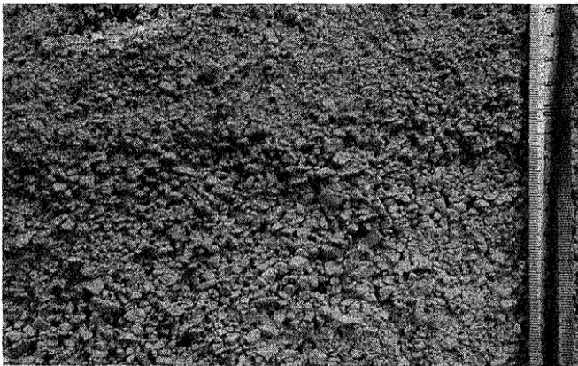
FIG. 3. — Gravière au Sud de Réthel montrant des lits de débris anguleux de craie blanche assez bien calibrés, à interstices ouverts.
