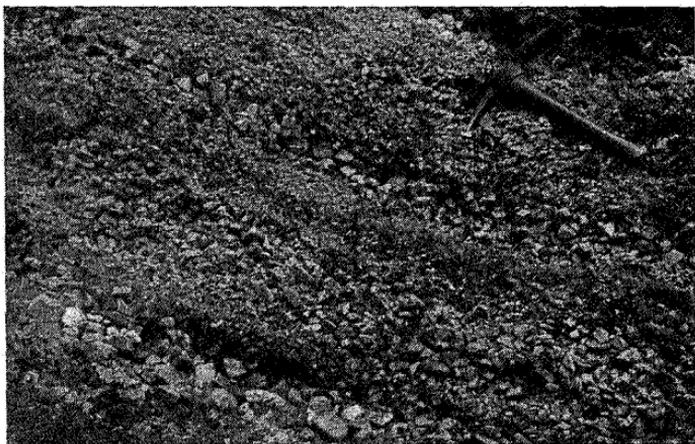
FIG. 4. — Gravière à Visé dans un déblai de phtanites viséens probablement brisés par pression tectonique.
