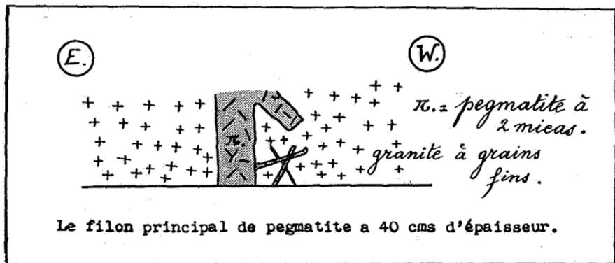
FIG. 6. — Pegmatite intrusive dans le granite du gisement de « Milamba » (Kasese) du « C. N. Ki ».
