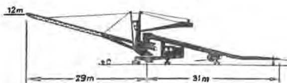
Fig. 5. Déverseur à bande transporteuse.
