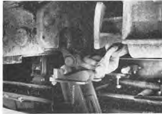
Fig. 13. Le levier est retiré du crochet verticalement et pivote en position initiale. Le crochet tombe dans l'étrier.
