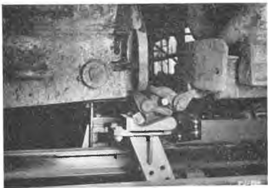
Fig. 12. Le levier d'étrier a placé l'étrier de l'accouplement (berline à gauche) sous le crochet (berline à droite).
