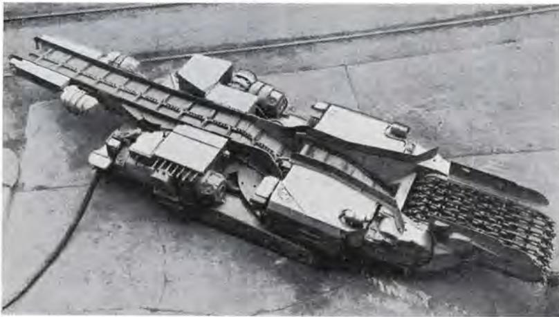
Fig. 12. — Plan d'ensemble du convoyeur Joy extensible.
