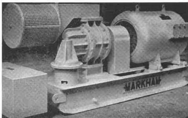
Fig. 23. — Compresseur basse pression du type Markham avec moteur électrique de 100 ch et filtre à air.
