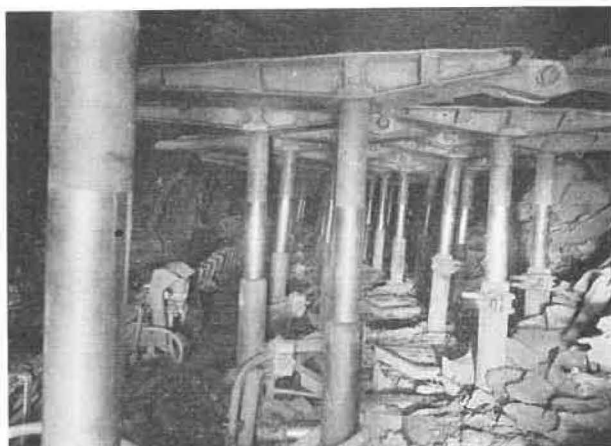
Fig. 15bis. — 34e/20. Soutènement en quinconce.
