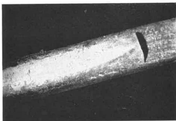
Fig. 13. — Fil fissuré avant contrôle magnétique.
