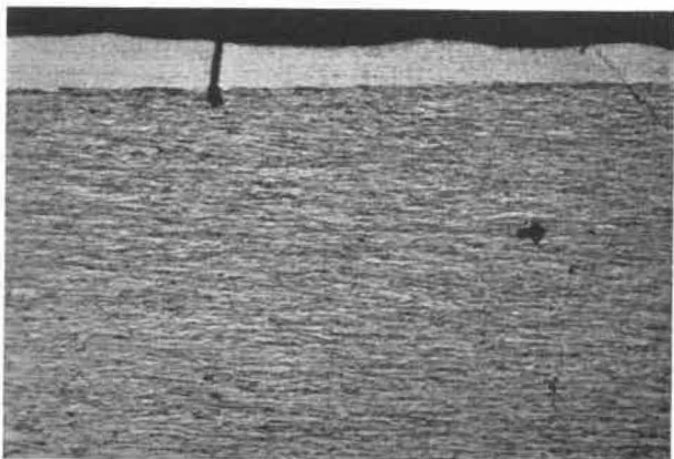
Fig. 12. — Forte usure intérieure et formation d'une couche martensitique avec fissure transversale.
