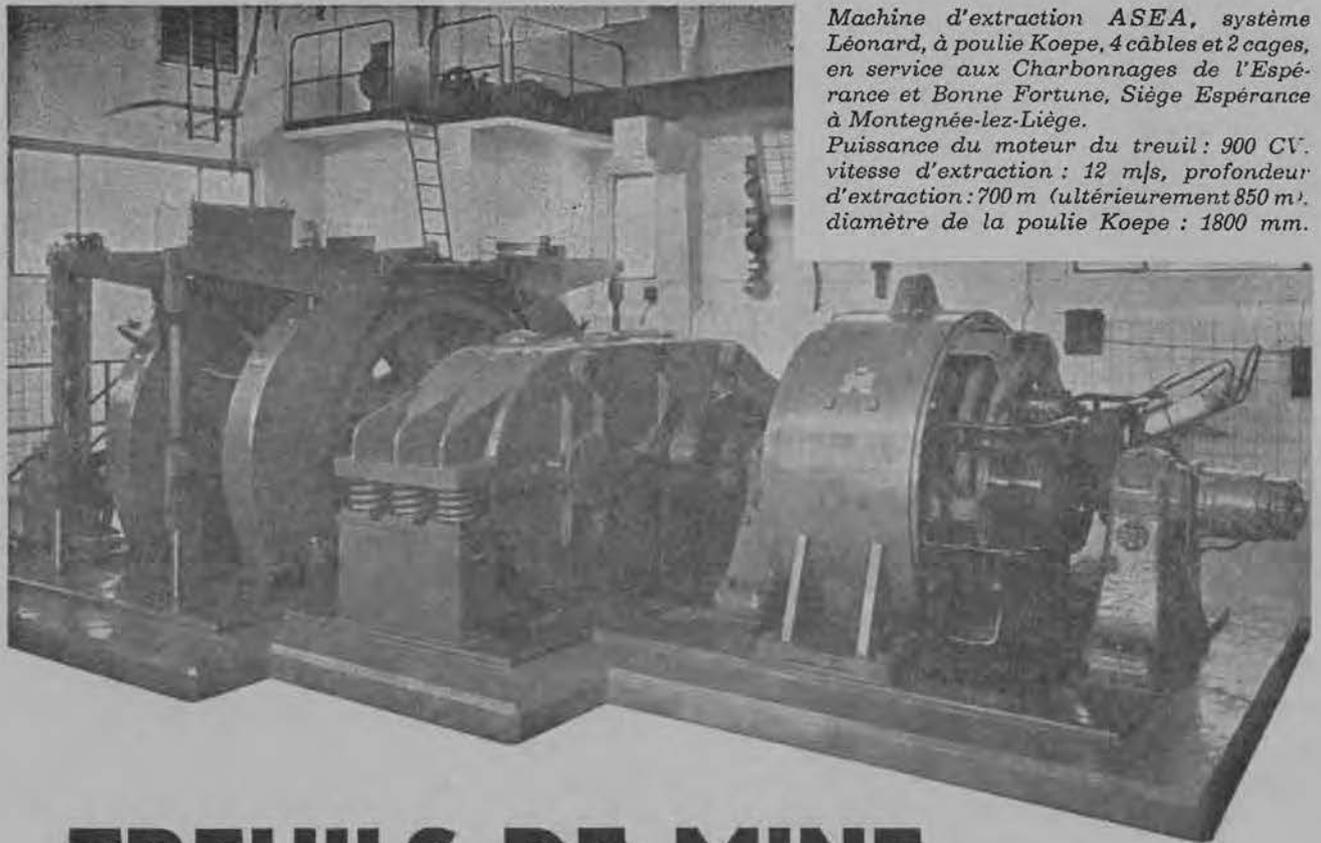
*Machine d'extraction ASEA, système Léonard, à poulie Koepe, 4 câbles et 2 cages, en service aux Charbonnages de l'Espérance et Bonne Fortune, Siège Espérance à Montegnée-lez-Liège. Puissance du moteur du treuil : 900 CV. vitesse d'extraction : 12 m/s, profondeur d'extraction : 700 m (ultérieurement 850 m), diamètre de la poulie Koepe : 1800 mm.*
