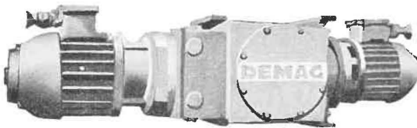
Fig. 11. — Tête motrice Demag équipée de 2 moteurs avec accouplement A.B.V. L'ensemble se place longitudinalement à côté du transporteur.
