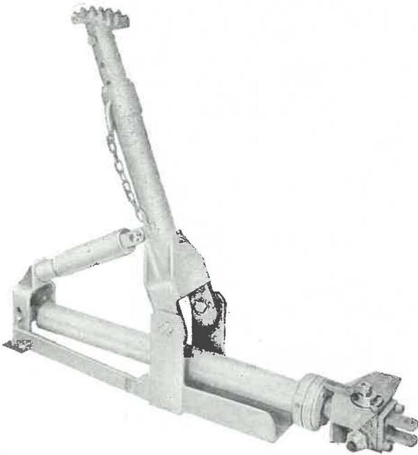
Fig. 28. — Pousseur hydraulique Gullick pour convoyeur blindé.
