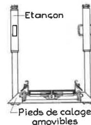
Fig. 4. — Couloir pneumatique à secousses.
