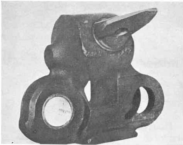
Fig. 3. — Chaîne de havage à pics réversibles. Le pic est calé dans son logement.
