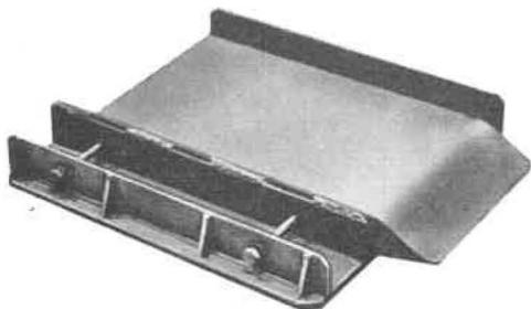
Fig. 6. — Chapeau de la pile avec les gouttières qui servent de logement aux bèles.
