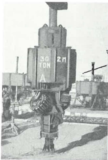
Fig. 21. — Couronne de forage de 2 m de diamètre du trou pilote.
