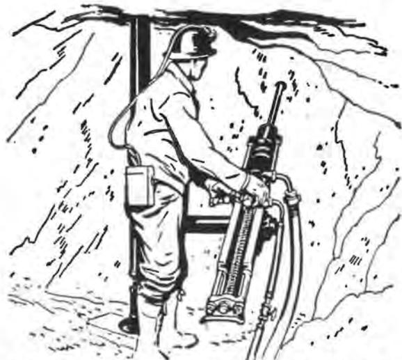
**Perforatrice à alimentation automatique** - l'alimentation auto réglable répond automatiquement à la pénétration de l'outil du forage, maintient une pression convenable sur l'outil, indépendamment de la nature de la roche rencontrée. Peut être fournie avec berceau en alliage d'aluminium permettant de forer de longues passes sans changement de fleurets.
