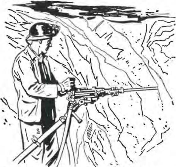
**Béquille d'alimentation et fonceuse légère** - faciles à transporter - rapides à installer - pour forage rapide à des endroits d'un accès difficile.
