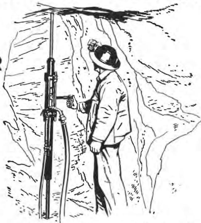
**Perforatrice à auto rotation pour forage en montant** - un équilibre bien étudié entre la pression d'alimentation et l'action du marteau donne un forage rapide - la poignée est placée en haut du cylindre pour pouvoir le tenir de façon sûre et aisée.
