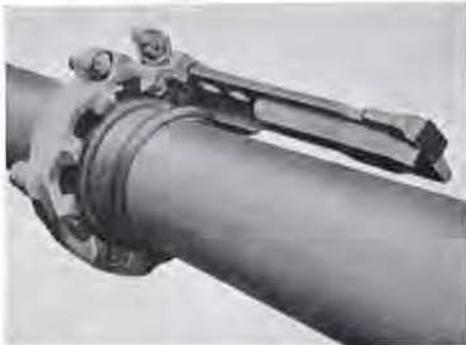
Fig. 12. — Accouplement tourneur du tube Rëuss en service sur une tuyauterie.
