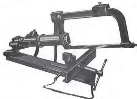
Fig. 35. — Scie à mouvement alternatif Göllner.
