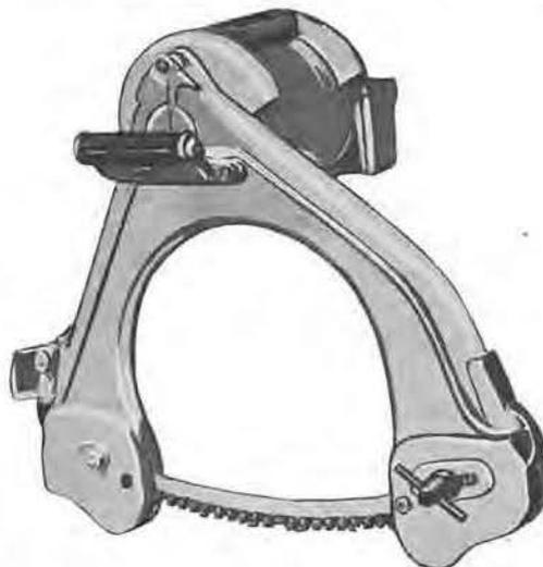
Fig. 55. — Scie à chaîne Stihl type E.B.L. La transmission du mouvement du moteur à la chaîne est directe.
