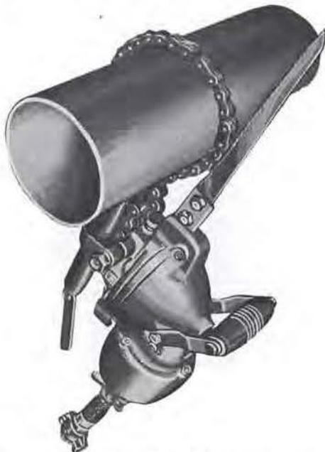
Fig. 34. — Scie à air comprimé Spitznas reliée par chaîne au tube à scier.
