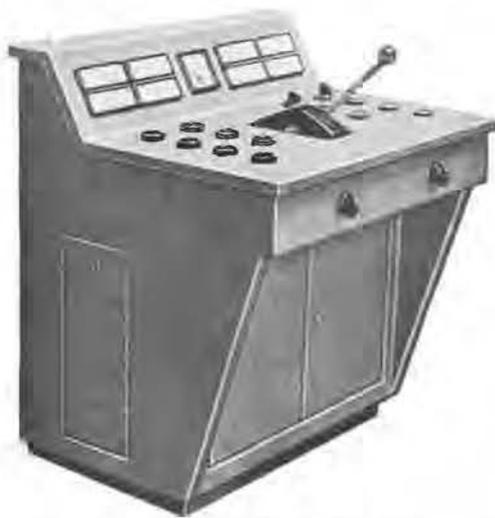
Fig. 15 — Pupitre de commande d'une installation d'encagement.
