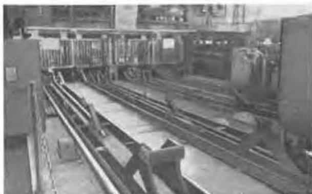
Fig. 5. — Dispositif d'éclusage des berlines par arrêt sur les butoirs.
