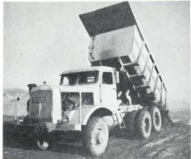
Fig. 20. — Camion Diesel de 200 ch et d'une capacité de 22 tonnes utiles, employé pour la mise à terril.
