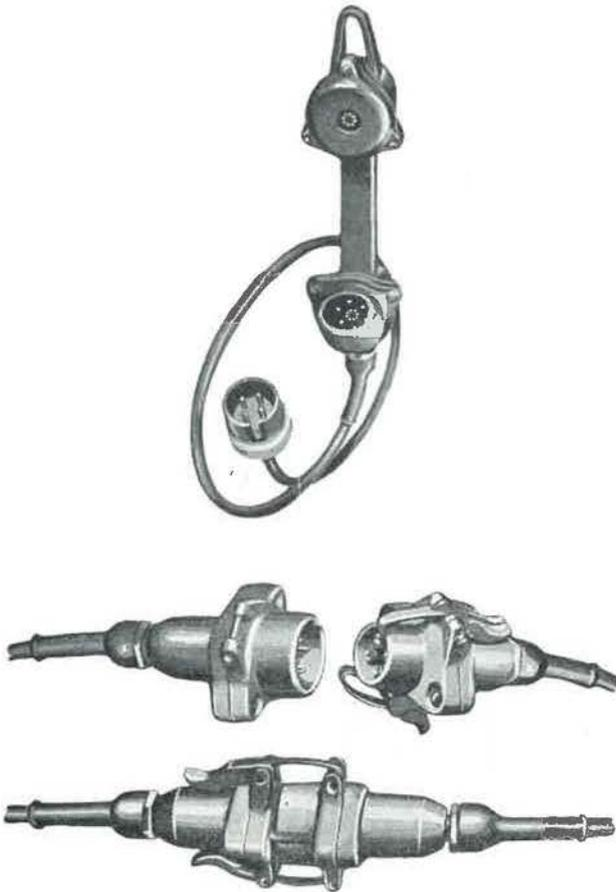
Fig. 15. — Raccord Généphone et combiné d'appel muni de sa prise adaptable.
