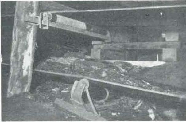
Fig. 5. — Couroie à brin inférieur porteur supportée de distance en distance par de petites batteries de rouleaux en augets.
