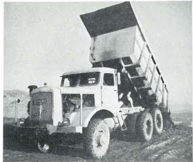
Fig. 20. — Camion Diesel de 200 ch et d'une capacité de 22 t utiles, employé pour la mise à terril.
