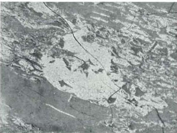
Fig. 5. — Houille brillante avec couches de micrinite granulaire.
