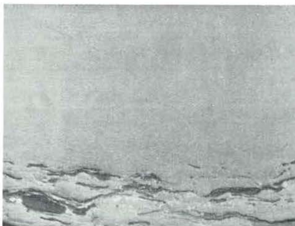
Fig. 2. — Houille brillante avec vitrinite sans structure (collinite).
