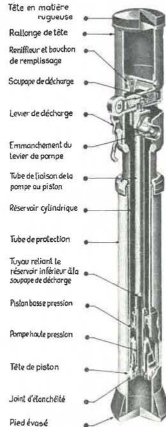
Fig. 1. — Étauçon Dowty type « Monarch ». On remarque la rallonge adaptée sur la tête de l'étauçon.
