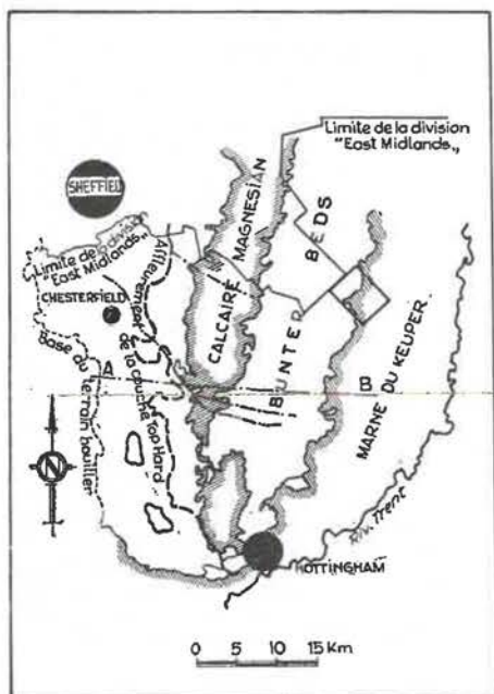
Fig. 1. — Limites des gisements et des affleurements des différents faisceaux dans le Nottinghamshire et le Nord Derbyshire.
