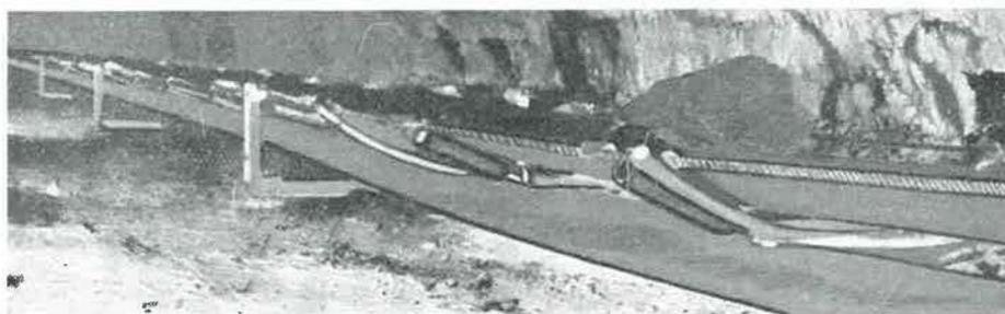
Fig. 21. — Convoyeur à courroie suspendu.
