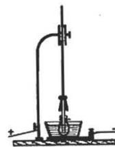
Fig. 3. — Voltmètre à l'argent. Appareil reproduisant l'unité légale de courant (ampère). L'anode (+) se compose d'une baguette d'argent, la cathode (—) d'une capsule en platine et l'électrolyte d'une solution de nitrate d'argent.
