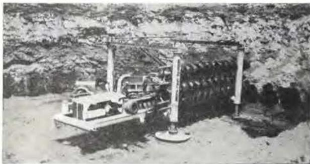
Fig. 9. — La machine de taraudage.
