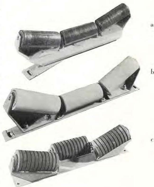
Fig. 1. — Batteries de rouleaux.
