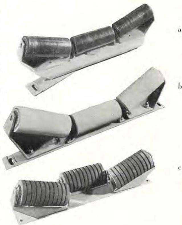
Fig. 1. — Batteries de rouleaux.
