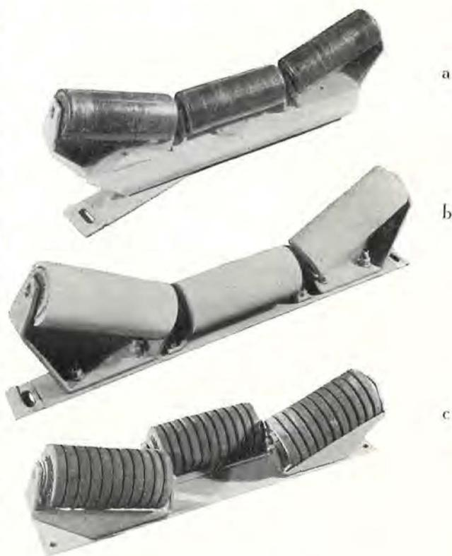
Fig. 1. — Batteries de rouleaux.
