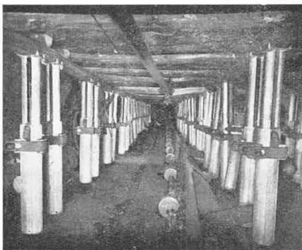
Fig. 15. — Taille en semi-dressant équipée d'étauçons en aluminium Alco.
