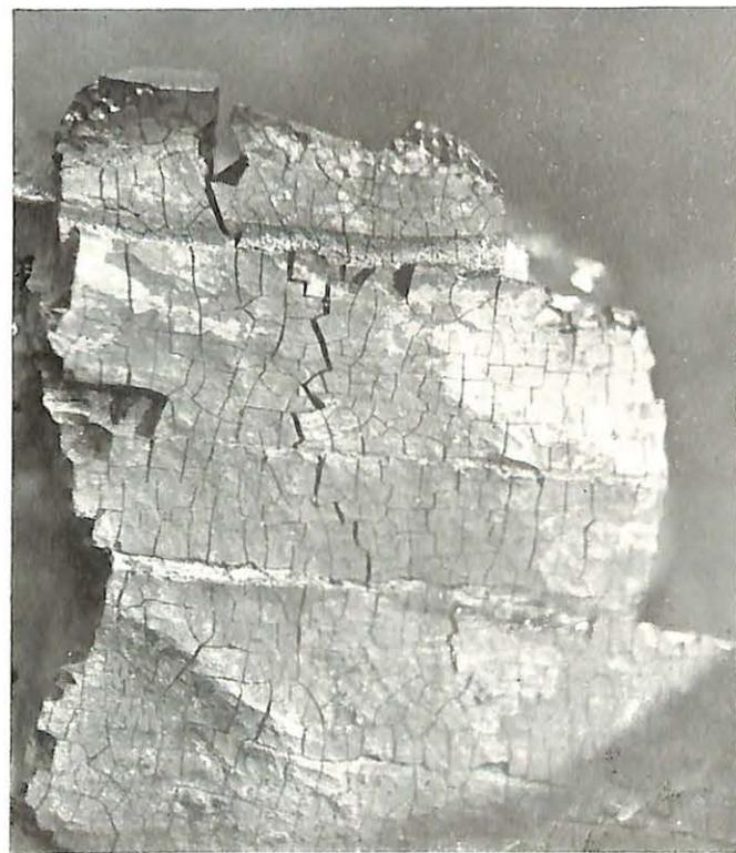
Fig. 4. — Lignite de Roumanie, avec fissures de retrait dans le vitrain. Les fissures de retrait présentent de même dans le vitrain des charbons belges. — Grandeur naturelle.
