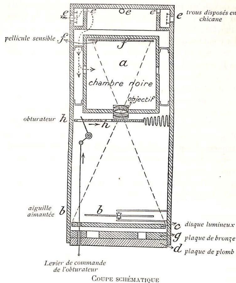
On fixe contre cette plaque une rondelle en plomb destinée à prendre, du côté intérieur, l'empreinte des quatre trous et du côté extérieur, l'empreinte de la tête de la carotte préparée spécialement.
