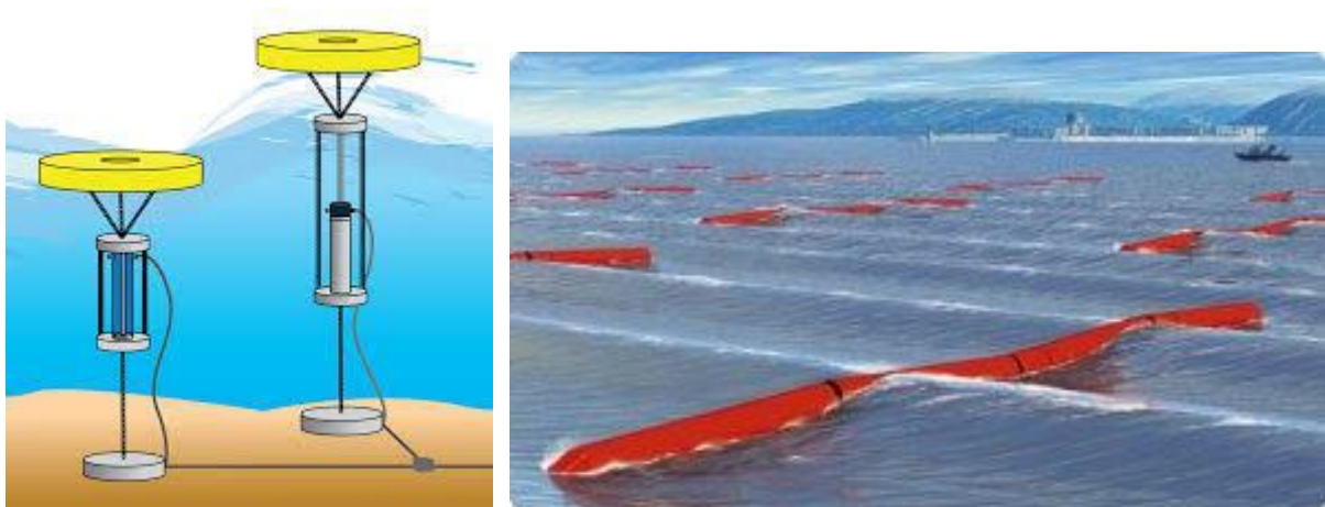
Figuur 1.12. Voorbeelden van een point absorber en een multiple point absorbers (attenuator) ( http://undertheblog.wordpress.com/2014/02/17/wave-energy-conversion-the-physics-and-the-applications/ )
