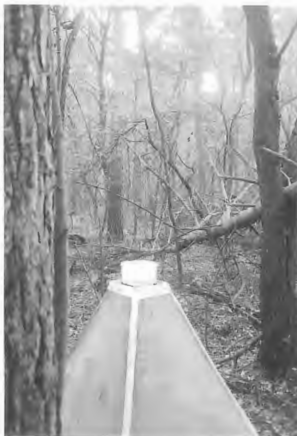
Fig 1. Beeld van een eklektor met schuine zijwanden en een wesperval bovenop.
