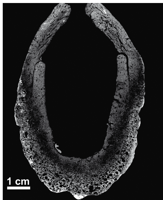
Fig. 10 – Coupe longitudinale passant par le centre du plus grand diamètre du creuset n°1 de Berloz observé en microtomographie aux rayons X ( \mu CT-Scan). De l'extérieur vers l'intérieur, le lut recouvre et débord largement la partie inférieure du creuset. Une surface de décollement du lut est observée dans le quart supérieur tandis qu'on remarque dans les autres zones la fusion des deux couches en une seule, avec une vitrification de plus en plus forte vers l'extérieur et surtout vers la base. © Image acquise et droit : Erik van de Gehuchte, Service des collections, IRSNB.
