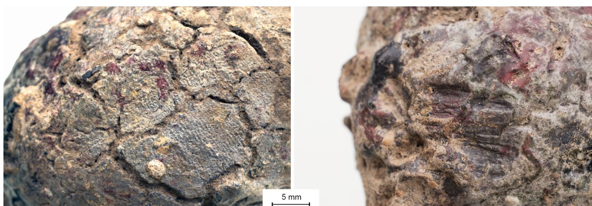
Fig. 9 – À gauche, empreinte de textile dans le lut du creuset n° 1 de Berloz et à droite, empreinte de charbon de bois dans la vitrification de ce même creuset. Photographies : Lise Saussus.
