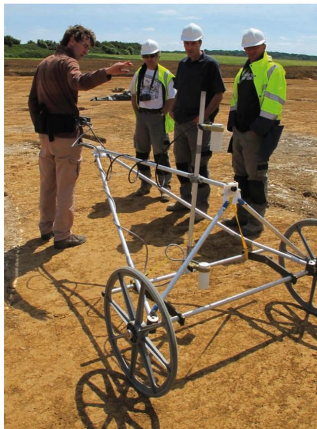
Fig. 11 - Parmi les outils testés sur le canal Seine-Nord Europe, figure la géophysique mise en œuvre sur site décapé en ayant recours à la mesure de susceptibilité magnétique du sol. Cette technique complète les observations de terrain et G. Hulin en évalue l'efficacité potentielle sur différents types de terrain. La géophysique a également été utilisée en surface des champs pour détecter les différents tracés de paléochenaux dans la vallée de l'Oise (photo G. Prilaux).
